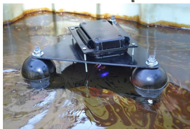
Prototype de bouée avec spectrophotomètre LED (source : source : AUB)
