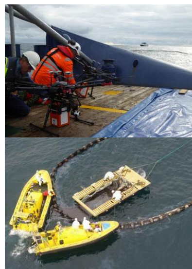
Préparation du DESMI Pyro-Drone ( haut ) et déconnexion du dispositif de collecte des résidus d'ISB ( bas ) (Source : NOFO )
