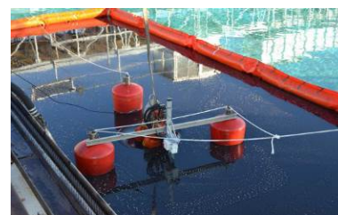
Capteur de capacitance monté sur un récupérateur à seuil (ici un DESMI Termite), en test dans les bassins de l'OHMSETT (source : AUB)
