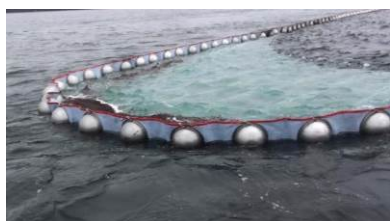
Ci-contre : dispositif de collecte des résidus de brûlage, fixé à une section de DESMI Pyro-Boom (filet immergé, avec ligne frontale de ballasts) (Source : DESMI )
