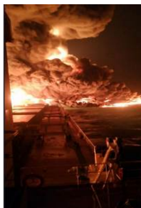
6 janvier : incendie spontané du déversement de condensats à partir des citernes ébréchées, vu depuis la passerelle du CF Crystal (gauche). 7 janvier : propagation de l'incendie à bord du Sanchi (droite) (Source : MSA)
