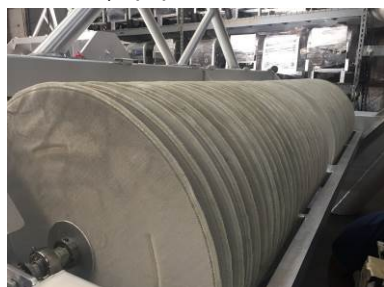
Récupérateurs Crucial à trains de disques oléophiles avec revêtement texturé (fuzzy discs) (Source : Alyeska Pipeline Service Company)
