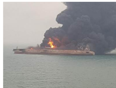
6 janvier : incendie spontané du déversement de condensats à partir des citernes ébréchées, vu depuis la passerelle du CF Crystal (gauche). 7 janvier : propagation de l'incendie à bord du Sanchi (droite) (Source : MSA)
