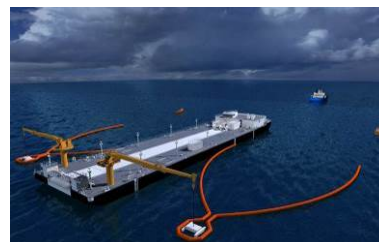
Schéma d'une barge récupératrice ECO avec déploiement (via bras de levage) de 2 récupérateurs oléophiles Crucial dans les poches de confinement de NOFI Current Buster 8 (Source: Alyeska Pipeline Service Company )
