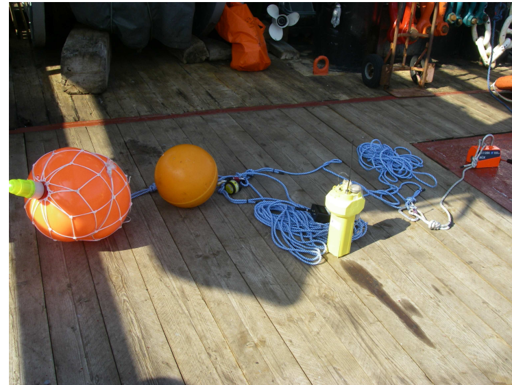
Chaîne de marquage du conteneur avec balise Argos, bouée, aimant.
