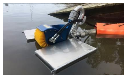
Petit récupérateur MicroMax Floating Skimmer (source : Lamor)
