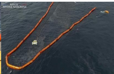
Gauche : Aspect du fioul émulsionné, fragmenté en amas visqueux (14.03.2019) ; Centre : opérations en mer de confinement de plaques de fioul par barrage flottant (ici déployé avec un paravane), et de collecte par écrémeur Lamor (seuil + module à brosse) de haute mer, opéré depuis l'Argonaute via un ombilic monté sur touret (19.03.2019) ; Droite : Remontée, sur le pont arrière de l'Argonaute, d'un filet de surface Thomsea chaluté pour la collecte d'amas disséminés de fioul visqueux (source : MN)
