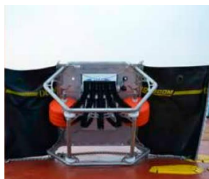
Vue de la face avant (i.e. « interne ») du module écremeur Octopus In-Line (source : DESMI)
