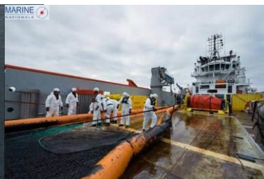
Gauche : Aspect du fioul émulsionné, fragmenté en amas visqueux (14.03.2019) ; Centre : opérations en mer de confinement de plaques de fioul par barrage flottant (ici déployé avec un paravane), et de collecte par écrémeur Lamor (seuil + module à brosse) de haute mer, opéré depuis l'Argonaute via un ombilic monté sur touret (19.03.2019) ; Droite : Remontée, sur le pont arrière de l'Argonaute, d'un filet de surface Thomsea chaluté pour la collecte d'amas disséminés de fioul visqueux (source : MN)
