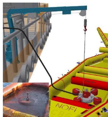
Schéma et photographie de déploiement du système d'allègement NorMar 4 Discharge System (source : AllMaritim)
