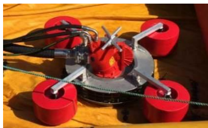
Pompe (DESMI DOP 200) sur châssis aluminium avec flotteurs amovibles (source : AllMaritim)
