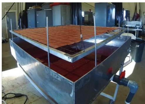
Prototype de structure/support d'absorbants (feuilles, tapis) en vue de tests normalisés (Source : Ohmsett/BSEE)
