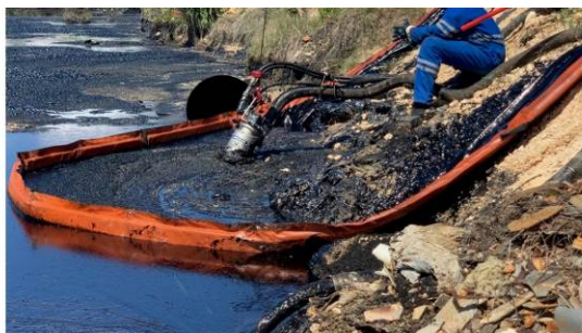
Pompe compacte à vis d'Archimède de faible débit (ici utilisée en aspiration directe) (source : http://aquaguard.com/ )
