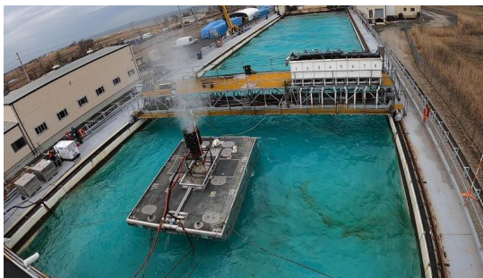
Ci-contre : Unité de brûlage montée sur barge, en phase de tests à l'Ohmsett (Source : BSEE)
