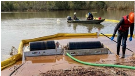
Collecte des épaisseurs de gazole accumulées sur les rives par récupérateurs à tambours oléophiles (source : LDEQ)
