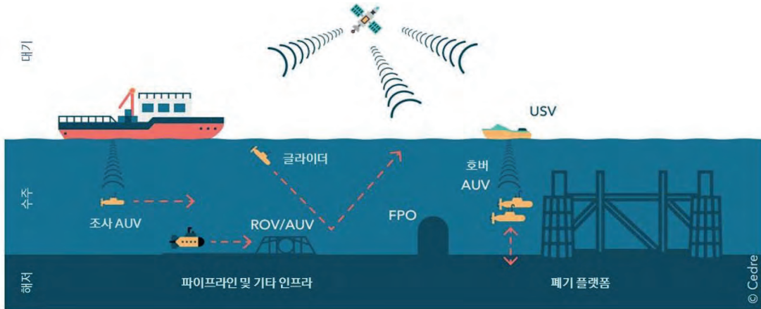
[그림 63] 지하, 지상 및 항공 기술: 원격작동차량(ROV); 자율수중차량(AUV), 글라이더, 자율수상차량 (ASV), 무인수상선박(USV), 고정익무인항공기(UAV), 회전익UAV, 위성.
