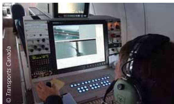
Poste d'analyse des images vidéos et radar à bord du Dash 8
