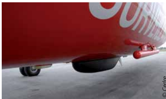
Capteurs UV, IR et RABL sous l'appareil
