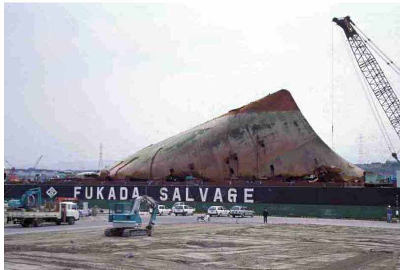
Proue du Nakhodka ramenée à terre après allègement. Source : Cedre.
