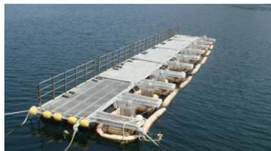
Vue des mésocosmes développés par KIOST : cylindres de polyéthylène (ci-contre) ; ponton flottant accueillant les 9 cylindres expérimentaux (ci-dessus). (Source : Joo et al, 2013)
