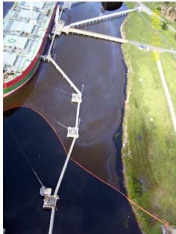
21/06 : Confinement à l'aide de barrages flottants à proximité du terminal CITGO (Source : USCG)
