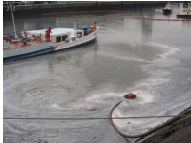
19/01 : Pompage par récupérateur à seuil Ro-Clean DESMI Minimax (Source : Total)
