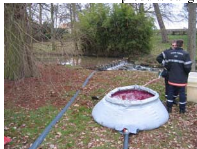
Bacs de décantation autoportants (Source : Ltn. Langlois - SDIS 44)
