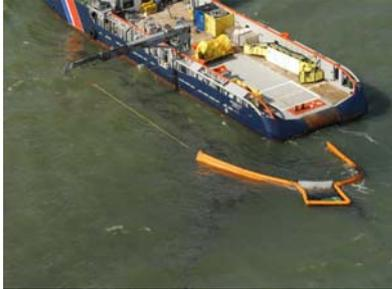
Mise en œuvre du chalut Thomsea par un bras latéral sur le BSAD Argonaute
