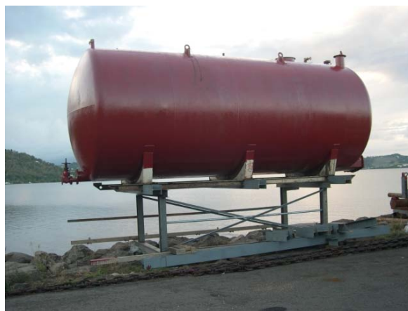
Flotteur du dispositif de remorquage des cuves 1 et 2 (source Cedre)
