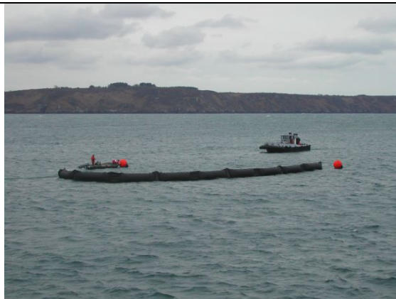
Installation du barrage pour les essais (source Cedre)
