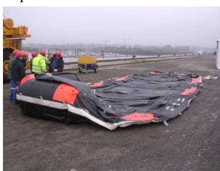
Stockage flottant ARISTOCK de 100 m 3 (gonflage avant mise à l'eau) (Source : Cedre)
