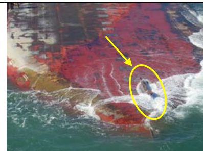
Renflouement : la brèche causée par la collision est visible (Source : USCG)
