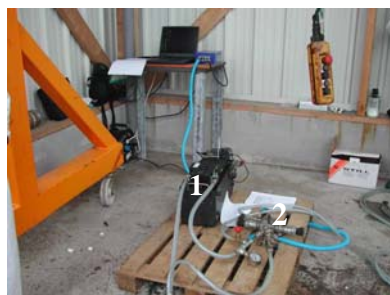
Le flux sortant est dérivé vers un spectrofluorimètre mesurant les hydrocarbures (1) et un turbidimètre (2) (Source : Cedre)
