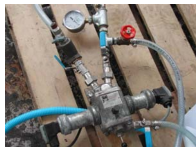
Vue du turbidimètre. (Source : Cedre)
