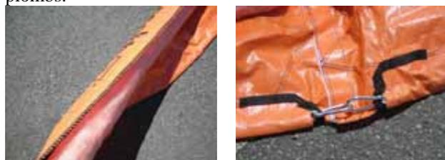
**Gauche** : Faces externe (côté enveloppe de polypropylène) et interne (côté absorbant) du barrage à jupe ; **Droite** : Système de connexion des tronçons par velcros et mousquetons (Source : Cedre)
