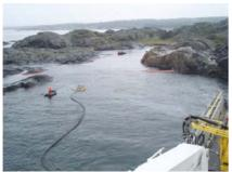
Déploiement du récupérateur mécanique HiVisc à partir du navire Olympic Poseidon (Source : NOFO)
