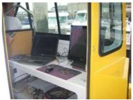
A gauche : Embarcation Survey de l'Ensieta. Au centre : Installation (sur puits existant) du sondeur, du logiciel navigation/stabilité, du récepteur GPS (Proflex Magellan), et du groupe énergie. A droite : PC/écrans de contrôle et module interface sonar (Source : Cedre)
