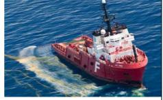
Epandage par le navire supply Lady Gerda –noter les rampes en position arrière (Source: AMSA)
