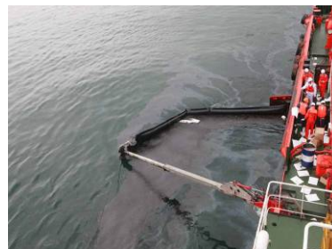
Gauche : Confinement en zone portuaire par barrages flottants ; Centre : Récupérateurs opérés à partir de navires non spécialisés ; Droite : Navire spécialisé (système intégré Lamor ) (Source : MSA)
