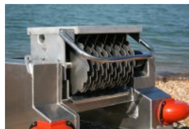
Le train de disques rotatifs à disques crantés des récupérateurs Komara Star (Source : Vikoma)
