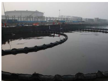
Gauche : Confinement en zone portuaire par barrages flottants ; Centre : Récupérateurs opérés à partir de navires non spécialisés ; Droite : Navire spécialisé (système intégré Lamor ) (Source : MSA)
