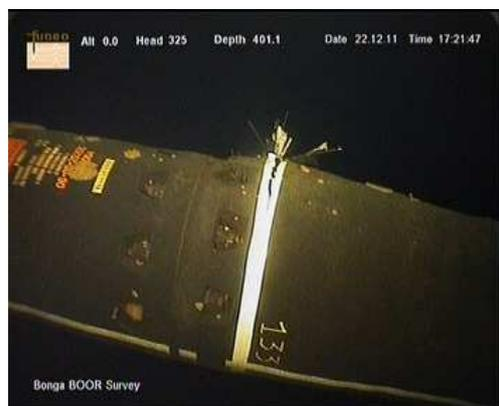
Vue sous marine de la brèche dans le flexible de chargement (Source : SNEPCo)
