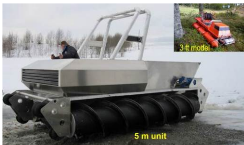
Le prototype de l'amphibie Oil Spill Fighter (en médaillon : la maquette) Source NOFO
