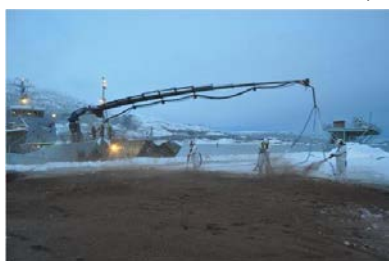
Système à vide ( Vacumkjempen Nord-Norge ) d'épandage et d'aspiration d'absorbants en vrac sur littoraux pollués (Source : NOFO )
