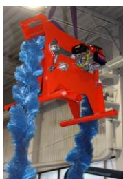
Récupérateur léger FoxTail Mini (gche) transportable par une personne (dte) (Source : hhenriksen.com)
