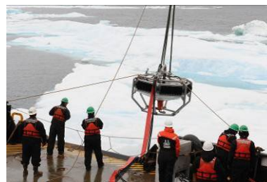
Exercice de mise à l'eau d'un écremeur DESMI Polar Bear , par grue à partir du baliseur Sycamore (Source : USCG )
