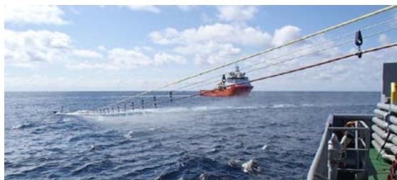
Prototype de BoomVane Spray testé en mer (Source : NOFO)
