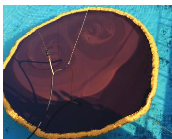
Prototype de T-Fence Boom TM HARBO testé dans les bassins de l'OHMSETT (source : HARBO)
