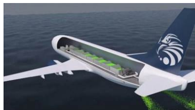
Schéma du système d'épandage de dispersants chimiques à partir d'un porteur Boeing 737-400 (Source: RVL Group)
