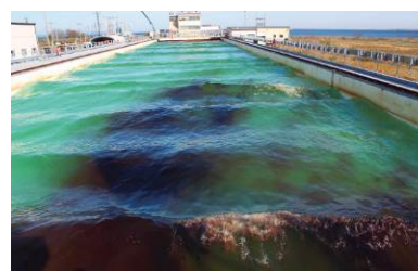
Evaluation, à grande échelle, de l'efficacité de dispersants agréés en conditions d'eau chaudes et de vagues (source : BSEE )
