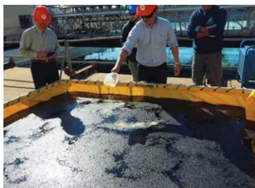
Tests à méso-échelle : épandage de gélifiant i-Petrogel (paillettes sur pétrole brut ANS ; gche ) ; écumage par tambours oléophiles (TDS Elastec ; drte ) (Source : OHMSETT )
