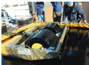
Tests à méso-échelle : épandage de gélifiant i-Petrogel (paillettes sur pétrole brut ANS ; gche ) ; écumage par tambours oléophiles (TDS Elastec ; drte ) (Source : OHMSETT )
