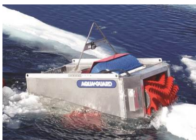
Prototype RotoX modifié pour récupération en milieu englacé (source : Aqua-Guard)
