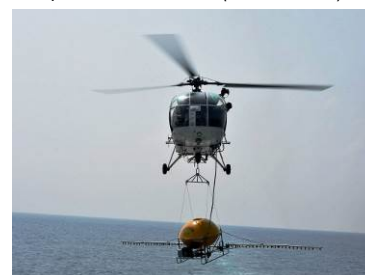
09/02/17 : Intervenants (ICG et volontaires) arimant des barrages pour confiner les arrivages sur le littoral d'Emavur (Source : B. J. Ramalingam, DR) ( gauche ) ; 03/02/17 : Application de dispersants chimiques par hélicoptère (épandeur de type Vikoma TC3) (Source : PTI) ( droite )
