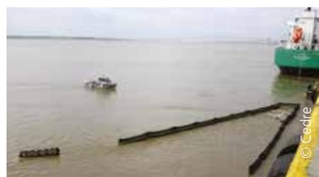
Utilisation du *Speed Sweep* en configuration statique en association avec le *Ro-Kite*
