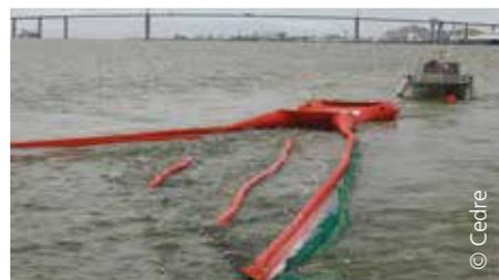
Essai dynamique du *LMOS Sweeper 15* avec deux bateaux
