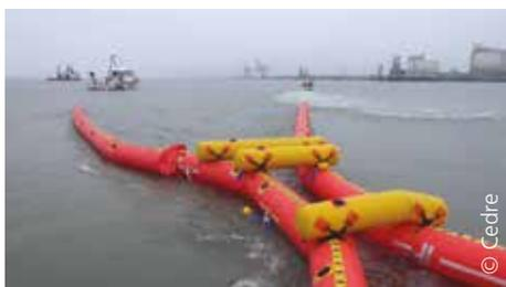
Mise en œuvre du *Current Buster 4* en mode dynamique à l'aide de deux bateaux
