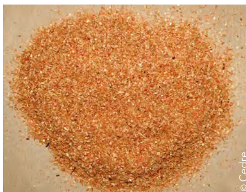
Les absorbants en vrac sont utilisés (dans les zones confinées) pour augmenter l'épaisseur et la viscosité du liquide à la surface de la mer ou pour intervenir sur les surfaces solides polluées.
