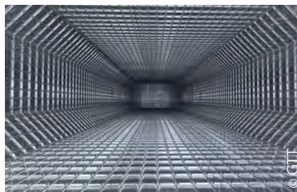
Réservoir de stockage pour le transport maritime de GNL
