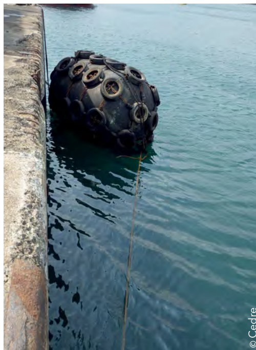
Défenses Yokohama utilisées pour permettre l'approche entre deux navires
