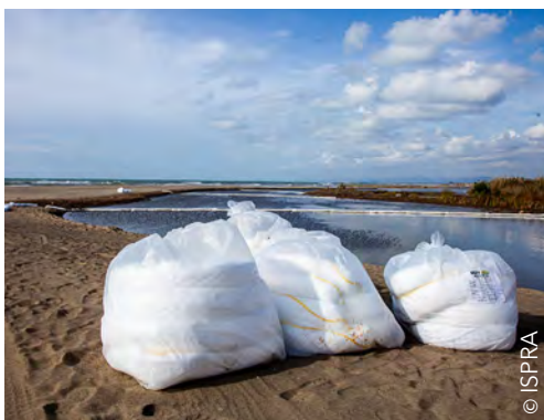
Les boudins absorbants sont principalement utilisés pour contenir des produits sur la surface de la mer lorsqu'ils sont utilisés en combinaison avec des feuilles absorbantes ou des absorbants en vrac.
