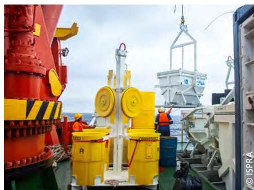
Racks spécifiques où ont été positionnés les fûts récupérés au fond de la mer par un ROV
