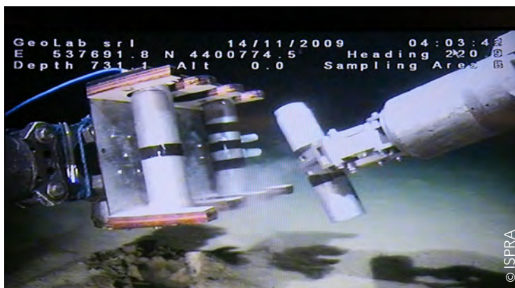
Échantillonnage de sédiment avec un ROV sur le fond marin profond.
