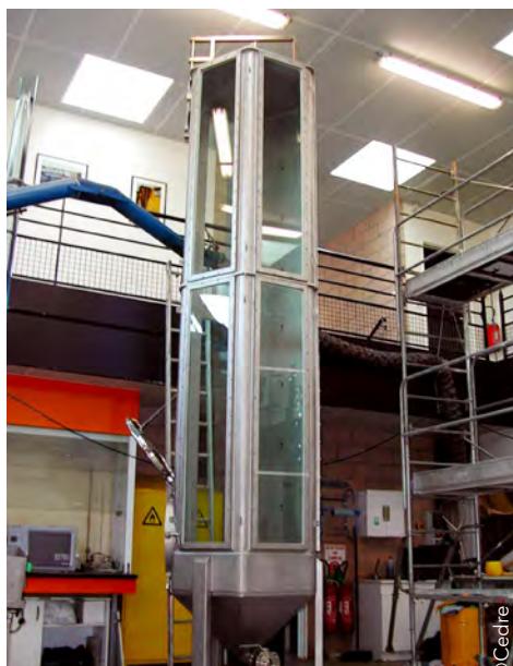
Colonne d'expérimentation étudiant le comportement d'un produit chimique (ou hydrocarbure) lors qu'il remonte (produit flottant) ou descend (produit coulant) dans la colonne d'eau
