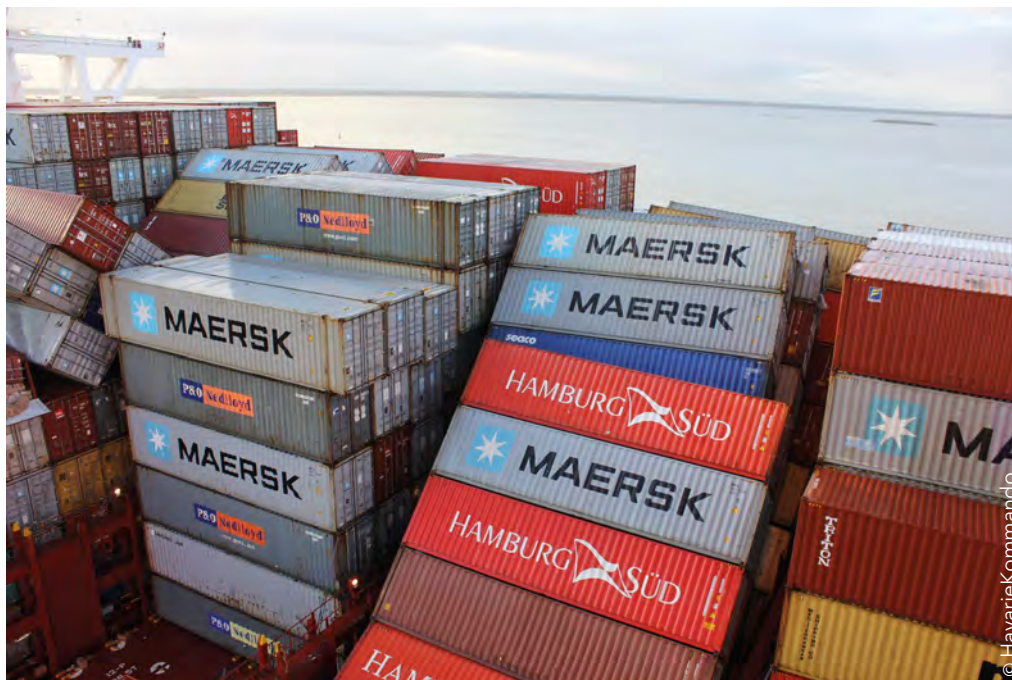
Conteneurs endommagés à bord d'un porte-conteneurs
