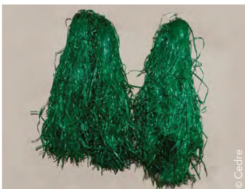
Des absorbants en écheveaux sont appliqués pour récupérer les polluants liquides flottants avec une viscosité moyenne / élevée.
