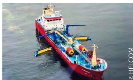
Navire citerne équipé par l'AESM, disposant d'un équipement d'intervention en matière d'hydrocarbures
