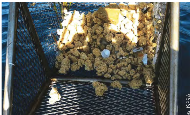
Récupération des paraffines avec un panier spécial.
